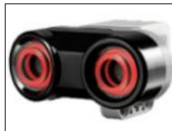
35-сурет. Ультрадыбыс датчигі
