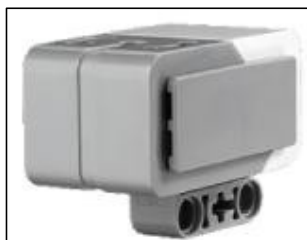
33 сурет. Гироскопиялық датчик
