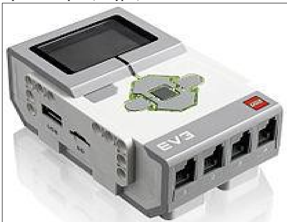
32-сурет. EV3 Микрокомпьютері
